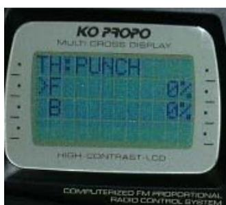
Esta función regula una reacción más rápida al primer “toque” del gas o el freno, de manera que el servo no siga la progresividad que le marque el gatillo y se mueva hasta una posición previamente programada como un “interruptor”.
