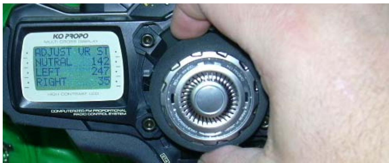
Para un buen ajuste asegúrese de alcanzar los topes mecánicos con firmeza. Una vez presentados los valores en pantalla (puede hacerlo tantas veces como quiera hasta que se asegure de que ha alcanzado los topes mecánicos), pulse Intro y entrará en una pantalla similar que regula el potenciómetro del acelerador/freno.
