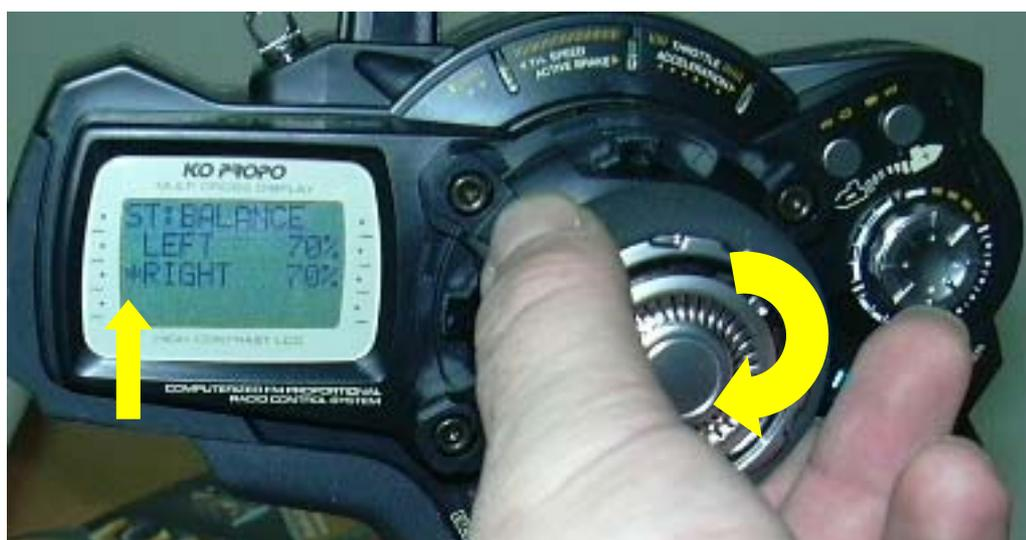
**NOTA:** Si a pesar de regular el 100% del recorrido hacia alguno de los lados su modelo sigue sin alcanzar el tope mecánico de la dirección, comprueba que el recorrido programado en la función ST TRAVEL (que se explica a continuación) es el suficiente. De no ser así, increméntelo y después vuelva a regular los topes independientes hacia cada lado de ST BALANCE. Si continúan los problemas, asegúrese de que la timonería de su modelo esta bien montada.
