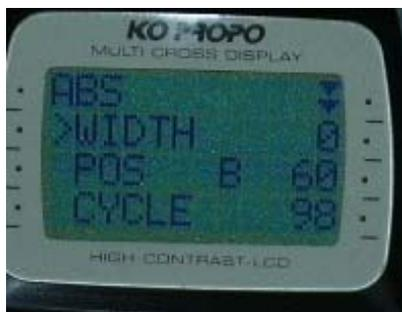
En esta función se regula el sistema anti-bloqueo electrónico de los frenos. Pulsando Intro cuando el cursor esta situado a la izquierda de ABS se accede a la ventana que veis a la izquierda. Girando el Jog Dial se coloca el cursor a la izquierda de la regulación sobre la que se quiera actuar, y pulsando nuevamente Intro se accede a la ventana particular de regulación de cada una de ellas.
