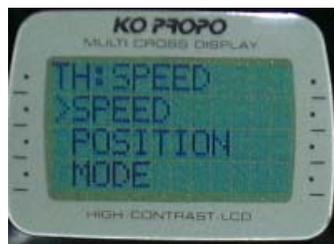
La función TH SPEED regula la velocidad a la que actúa el servo de gas/freno. Pulsando Intro cuando el cursor esta situado a la izquierda de TH SPEED se accede a la ventana que veis a la izquierda. Girando el Jog Dial se coloca el cursor a la izquierda de la regulación sobre la que se quiera actuar, y pulsando nuevamente Intro se accede a la ventana
